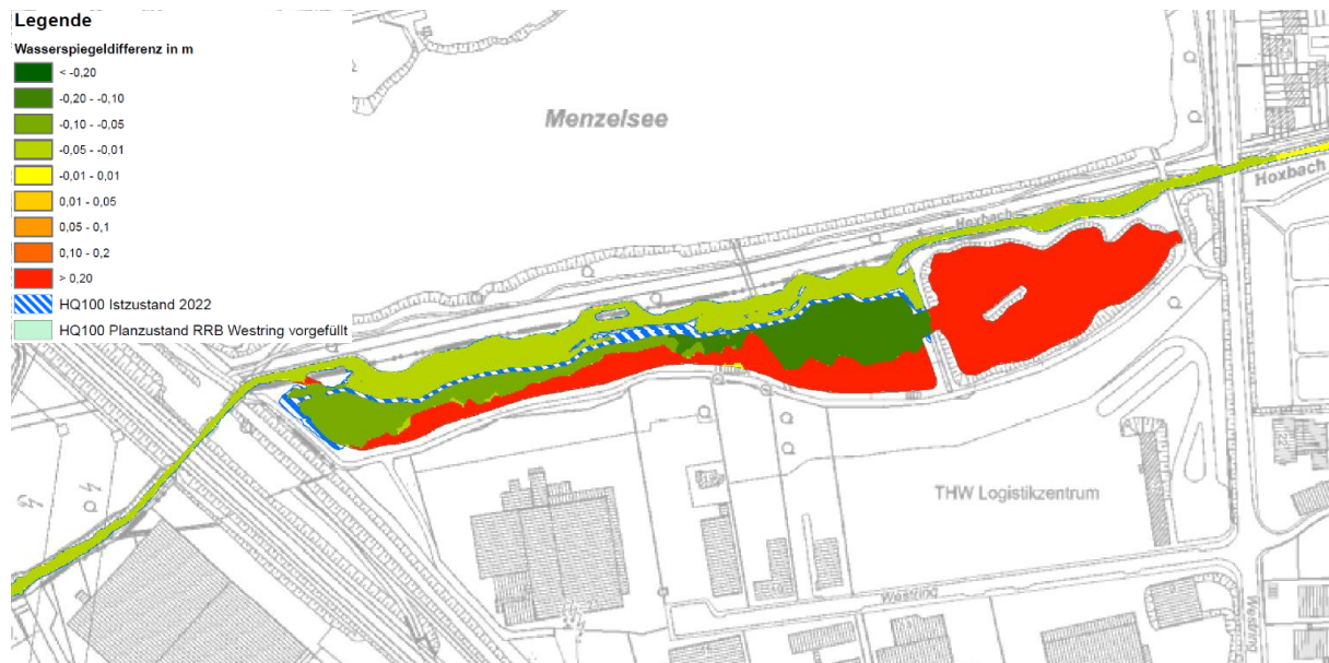
Abbildung 4-3: Wasserspiegeldifferenzen HQ100 für den Lastfall RRB vorgefüllt
