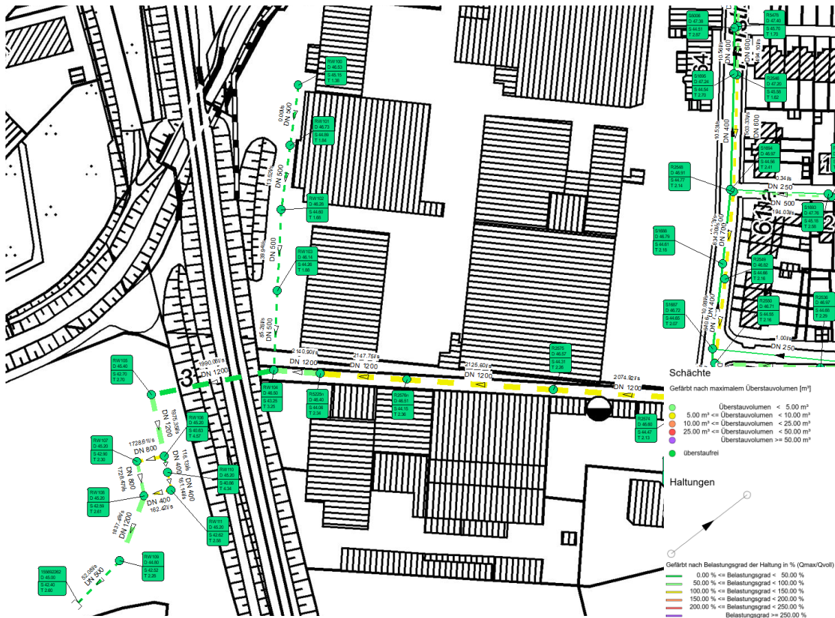
Abbildung 10: Ergebnis der hydrodynamischen Kanalnetzberechnung für T=3s und D=60 min
