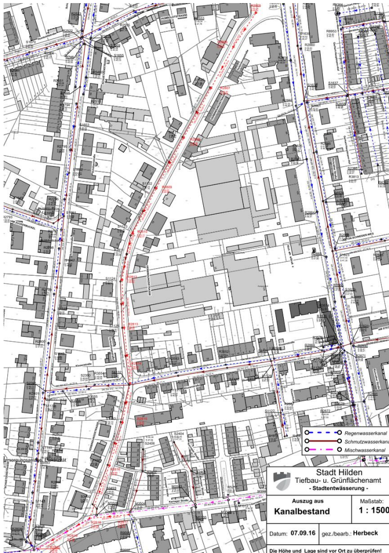
Abbildung 1: Kanalbestand, rot = zu sanierende Trasse
