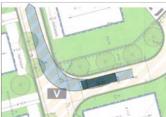
Abbildung 8: Fahrkurve für ein 3-achsiges Müllfahrzeug vom Zentralen Platz zur Erschließungsstraße
