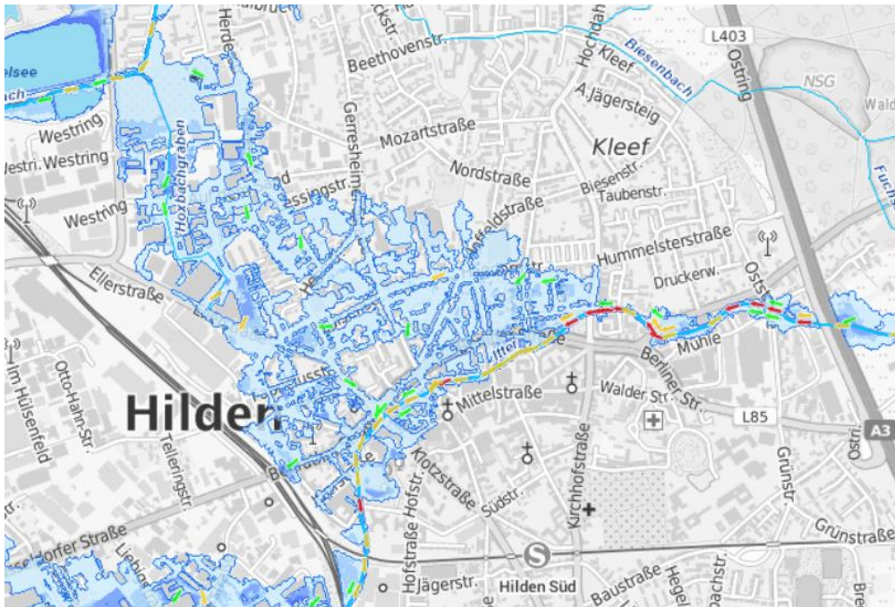
Abb. 5-1: Hochwassergefahrenkarte nach HWRMRL (HQ Extrem)
