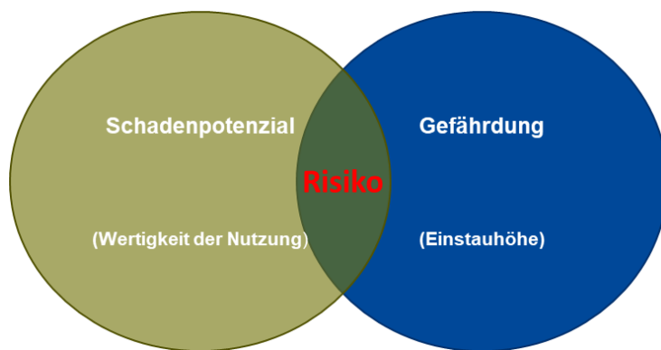
Abb. 3-1: Überflutungsrisiko als Kombination von Gefährdung und Schadenspotenzial
