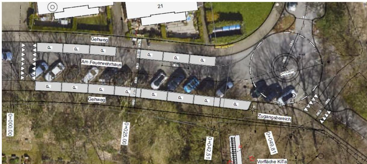
Abb. 10: Konzept für den hinteren Straßenquerschnitt „Am Feuerwehrhaus“
