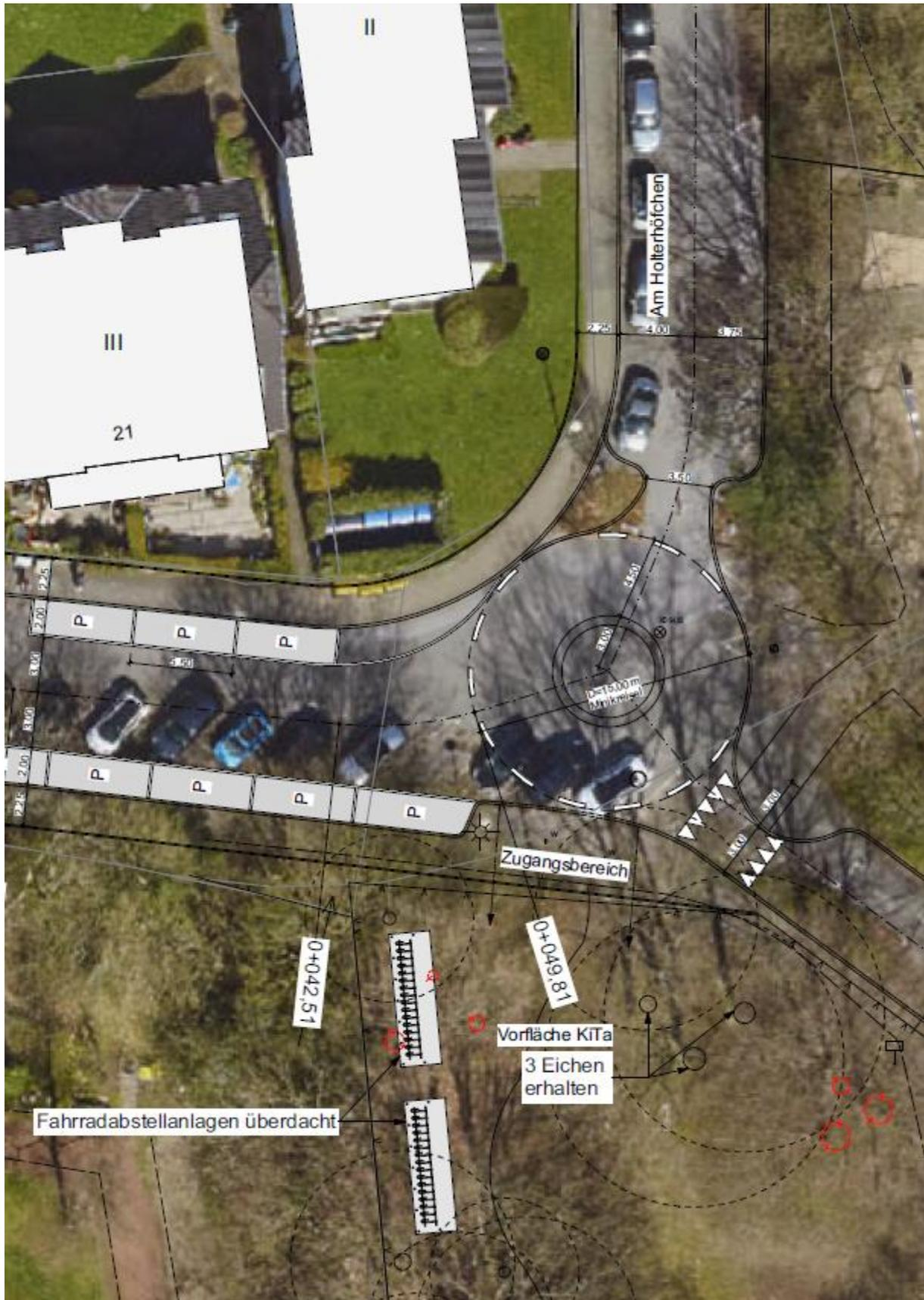
Abb. 9: Konzept für den Kreuzungsbereich „Am Feuerwehrrhaus“ / „Am Holterhöfchen“
