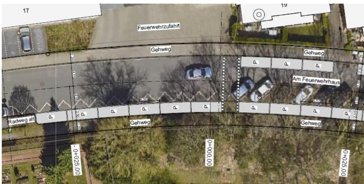
Abb. 11: Konzept für den Straßenquerschnitt „Am Feuerwehrhaus“ im Bereich der Feuerwehrezufahrt
