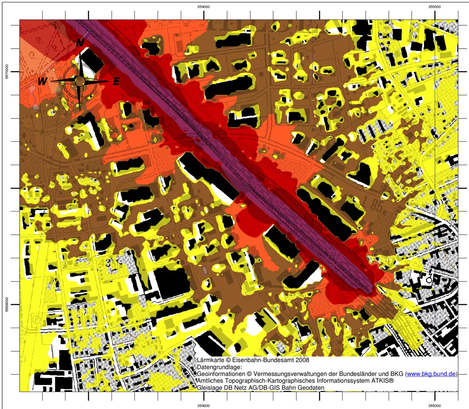
**Schienenlärm 8 Stunden - LNIGHT in dB (A)**
