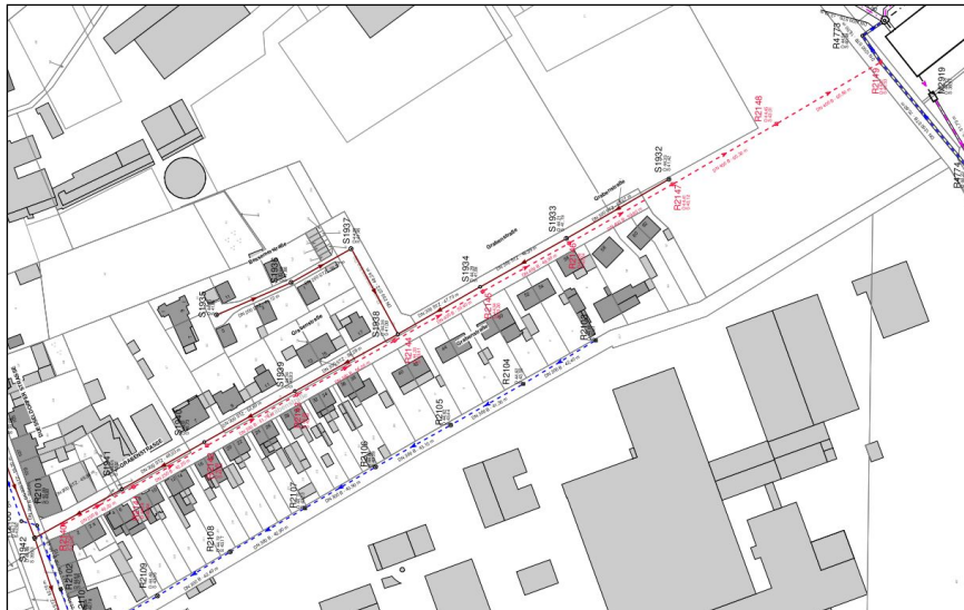
Abb. 4-1: Lageplan IST-Zustand (Quelle: Kanalnetzdatenbank tiffany)
