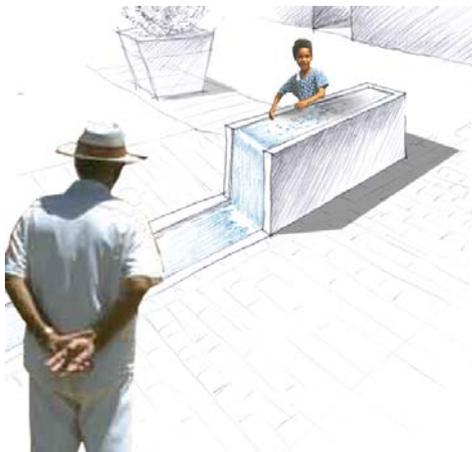
Der Wasserlauf selbst ist nur 40 cm breit und maximal 3 cm tief und somit bequem zu überschreiten oder zu durchfahren. Der flache Wasserfilm selbst ist maximal 2 cm stark. Die Seitenflächen der Vertiefung sind um 45° geneigt, so dass ein Stolpern nicht möglich ist. Während temporärer Großveranstaltungen kann die Wasseranlage abgestellt und die Platzfläche somit bis zur südlichen Bebauung der Mittelstraße ausgedehnt werden.
