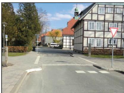
Bild 3-15: Fahrradstraße mit Bevorrechtigung am Knotenpunkt, mit Aufpflasterung. Die Fahrradstraße wird allerdings vor dem Knotenpunkt aufgehoben und nach dem Knotenpunkt wieder ausgewiesen (Rietberg).
