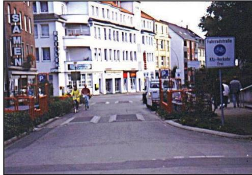
Bild 3-7: Plateau-Aufpflasterungen zur Geschwindigkeitsdämpfung (Gladbeck)
