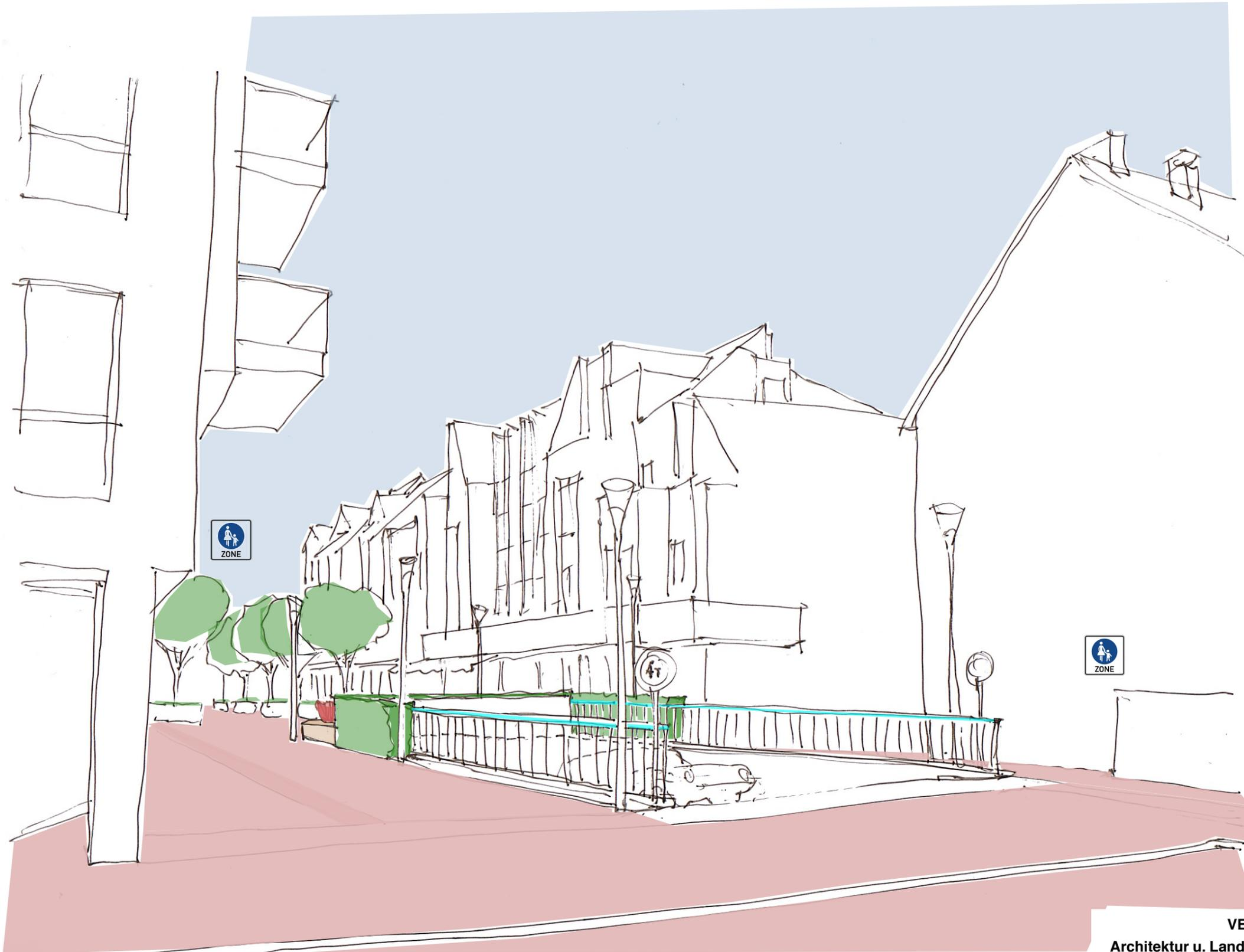
Blick auf die umgestaltete Einfahrtsrampe der Tiefgarage mit integriertem LED Licht in der Absturzsicherung
